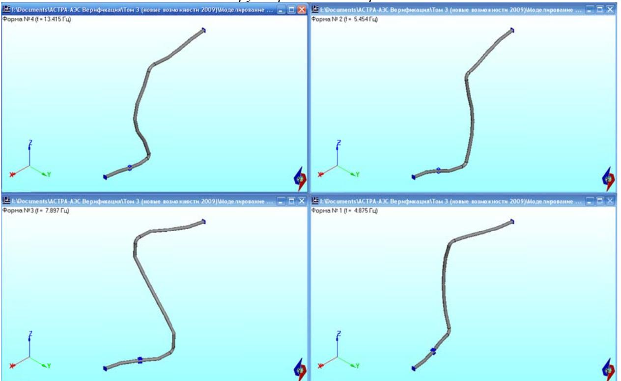
Рис. 26.10 Расчетные низшие формы собственных колебаний
