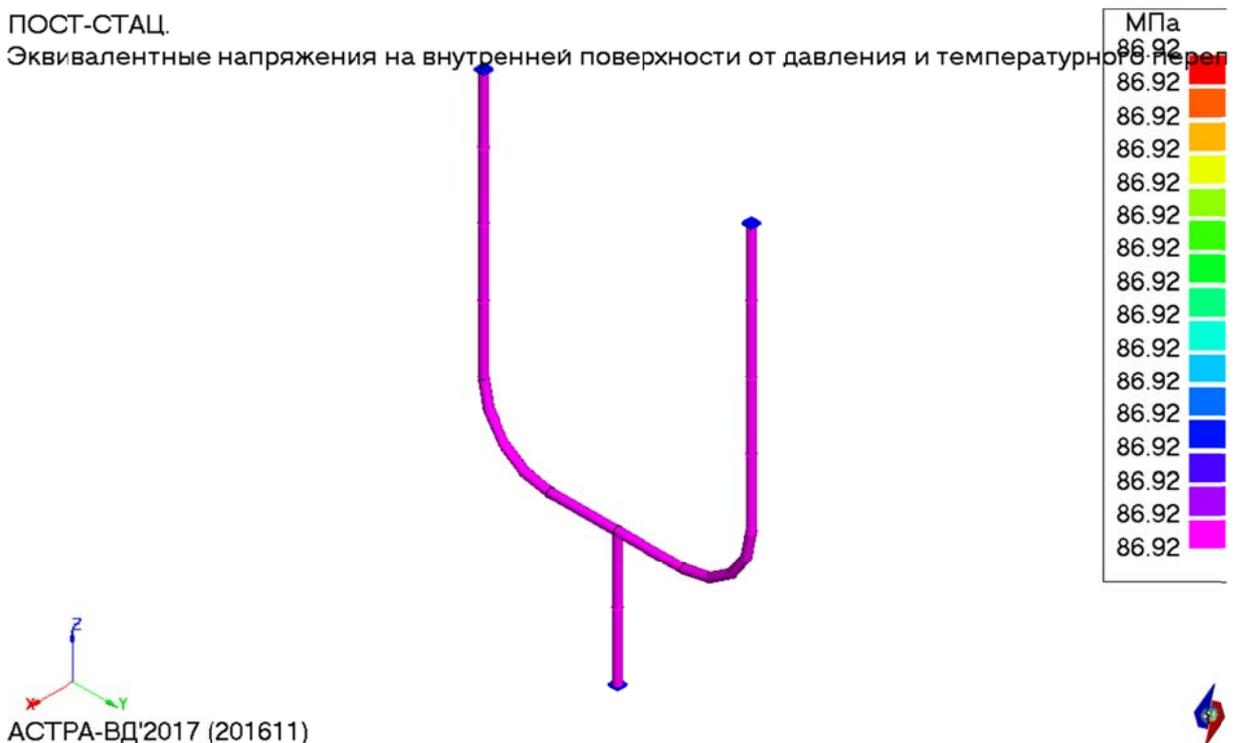
Рис. 20.3 Расчётные эквивалентные напряжения  $\sigma_{\text{ЭКВ}}$  на внутренней поверхности от давления и температурного перепада, МПа
