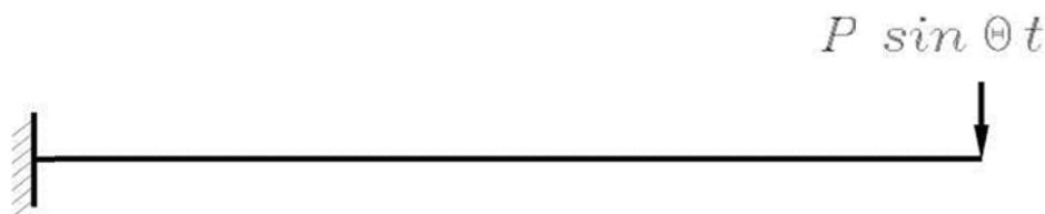
Рис. 12.1 Расчетная схема задачи: консольный стержень
